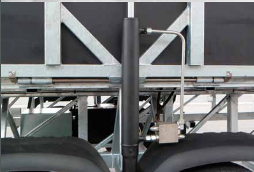
Vérin hydraulique de manœuvre des planchers (mise à niveau automatique)
