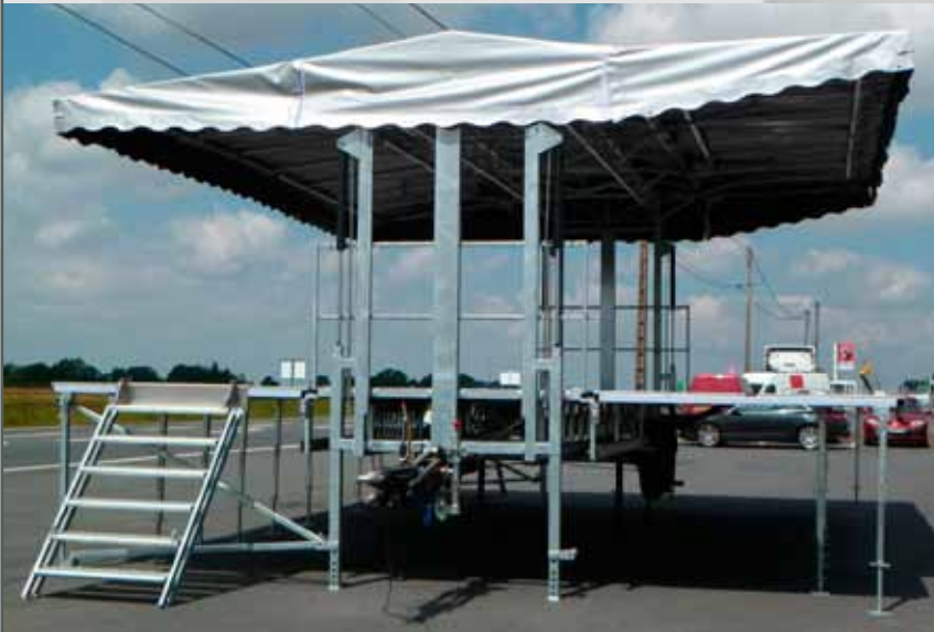
Relevage hydraulique de la scène
