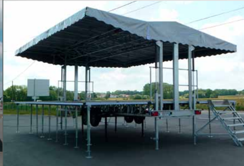
Toiture en position basse (accroche des projecteurs et mise en place des bâches)
